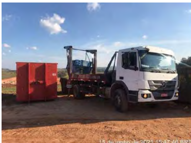
Foto 370 – Troca da caçamba de resíduo comum do canteiro industrial. (Data:15/06/2021)
