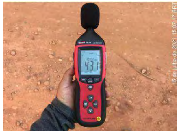
Foto 361 – Decibelímetro utilizado no monitoramento. (Data:15/07/2021)
