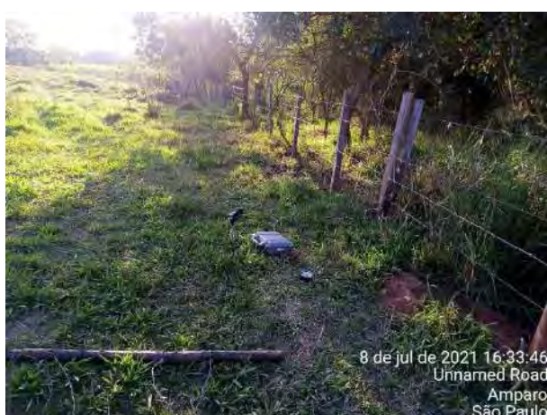
Foto 181 – Sismógrafo no primeiro receptor. (Data:08/07/2021)
