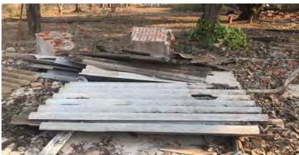
Foto 19. Telhas com amianto.
