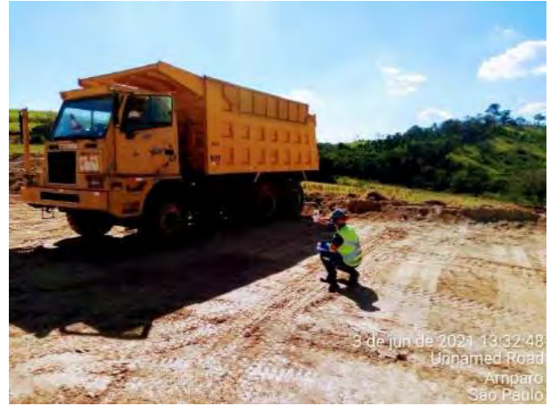
Foto 353 – Inspeção de fumaça preta do Caminhão Fora de Estrada. (Data:02/06/2021)
