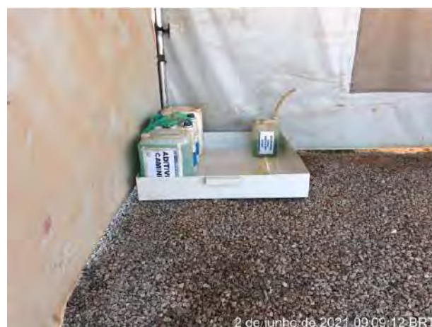
Foto 82 – Bandeja para contenção de produto químico em campo. (Data:02/06/2021)
